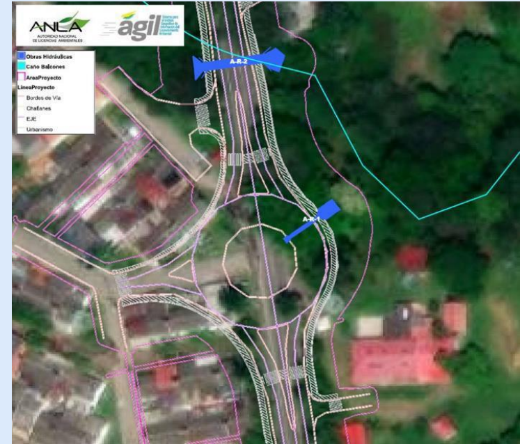
Obras hidráulicas requeridas en la Glorieta Restrepo.
